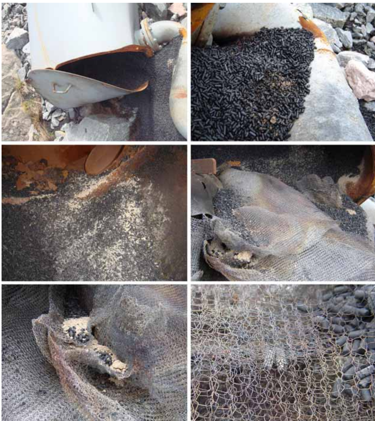
Figur 6-6 Filtermateriale, askelignende stoff og nettingduk av rustfritt stål fra luftfilteret med aktivt kull: bilde av filtermateriale som har runnet ut av filteret, med antydning av askelignende materiale (øverst til venstre, foto av Ø. Larsen, 31. mai 2007); rester av askelignende materiale på utsiden av filteret (øverst til høyre, foto av T. Skjold, 18. juli 2007); filtermateriale med askelignende stoff nær innløpet inne i filteret (til venstre i midten, foto av T. Skjold 18. juli 2007); duk av rustfritt stål med tydelige tegn til fargeforandring som tyder på at materialet har vært utsatt for høy temperatur (til høyre i midten, foto av T. Skjold, 18. juli 2007); nærbilde av duk med askelignende materiale (nederst til venstre, foto av T. Skjold, 18. juli 2007); nærbilde som viser to granulatpartikler av aktivt kull mellom lagene av rustfri duk (nederst til høyre, foto av T. Skjold, 18. juli 2007).
