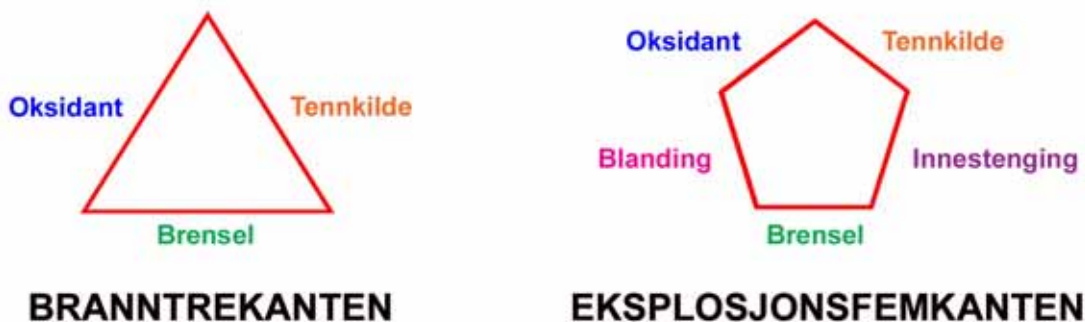
Figur 1-1 Branntrekanten (til venstre) og eksplosjonsfemkanten (til høyre) illustrerer de ulike kriteriene som normalt må være oppfylt for å realisere henholdsvis en brann og en kjemisk eksplosjon.
