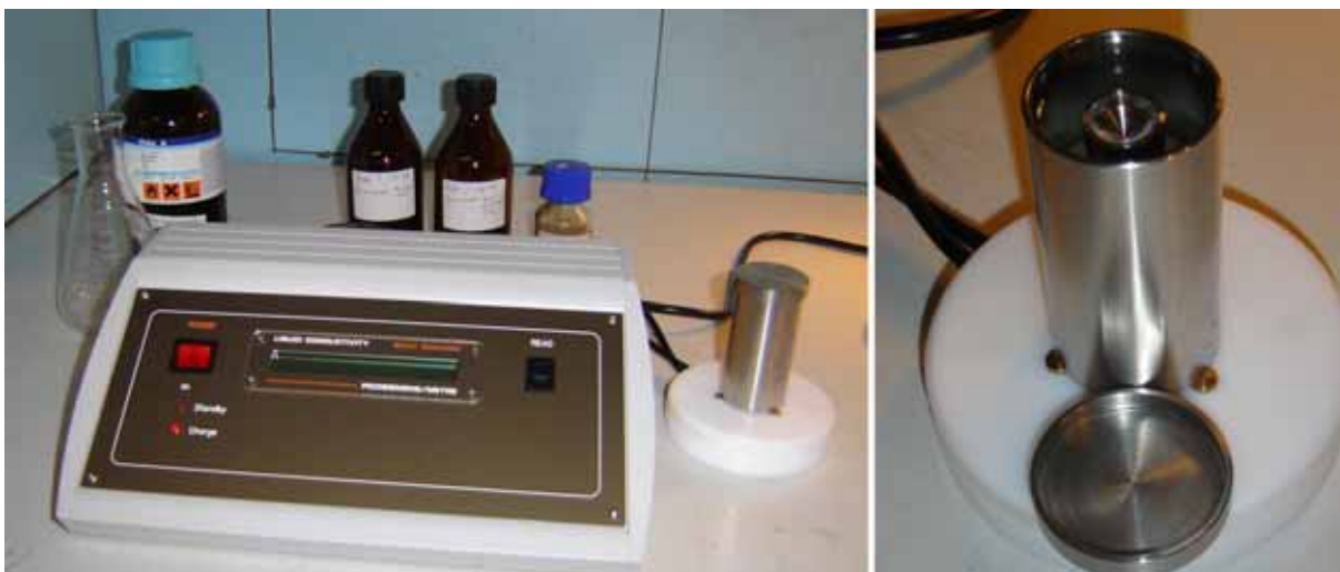
Figur 6-1 Instrumentet av typen 'Liquid Conductivity Meter, Model L40' fra Wolfson Electrostatics, med kalibreringsvæsken ( n -heptan) og 3 prøver av basisk 'waste' i bakgrunnen (til venstre); detaljbilde av selve målecellen (til høyre).
