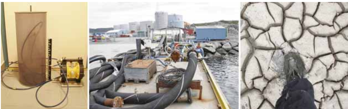
Figur 1-3 Apparaturen som ble benyttet for å undersøke effekten av syretilsetning i liten skala (til venstre); tankanlegget sett fra kaien, med slangene som ble brukt til transport av 'coker gasoline' fra tankbåtene til tankanlegget, pumpehuset og luttanken 'De Rijke' (i midten); massen som var igjen i Tankgård II dagen etter ulykken (til høyre); bilder fra Politiet.
